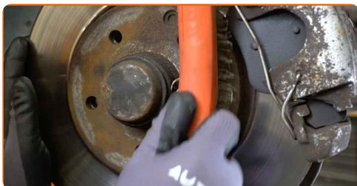
**21** Appliquez du produit sur la zone de contact entre le disque de frein et la jante. Utilisez du lubrifiant céramique.
