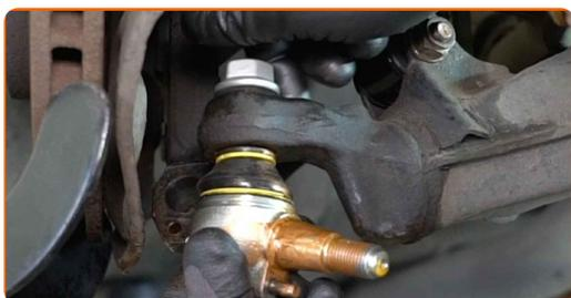
**16** Connectez le joint à rotule à la fusée d'essieu.
