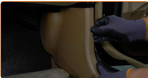
**5** Dévissez les fixations du panneau latéral sous planche de bord du côté passager. Utilisez la mèche Torx T20.
