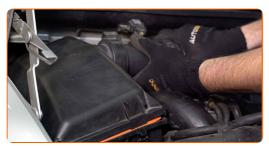
Appuyez sur les clips du couvercle du filtre à air pour les remettre en place.
