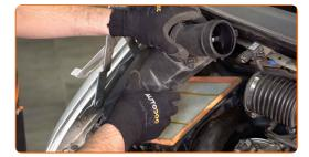
Retirez l'élément filtrant du compartment du filtre.
