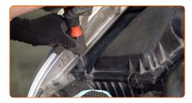
Déverrouillez les clips du couvercle du filtre à air.
