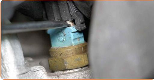
**31** Nettoyez le capteur de température du liquide de refroidissement. Utilisez une brosse métallique. Servez-vous d'un aérosol nettoyant multi-usages.
