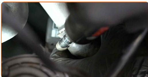
**30** Débranchez le connecteur du capteur de température du liquide de refroidissement. Utilisez un tournevis plat.
