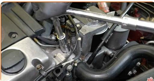
**33** Installez un nouveau capteur de température de liquide de refroidissement.
