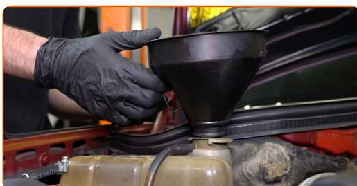
**42** Versez du liquide de refroidissement dans le réservoir.
