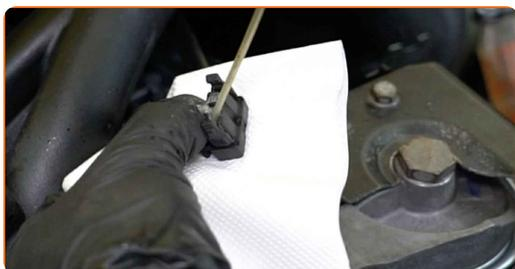
**36** Branchez le connecteur du capteur de température du liquide de refroidissement.
