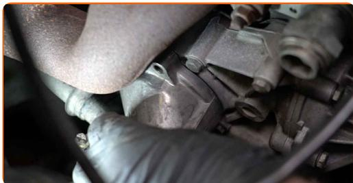
**26** Installez les boulons de fixation.
