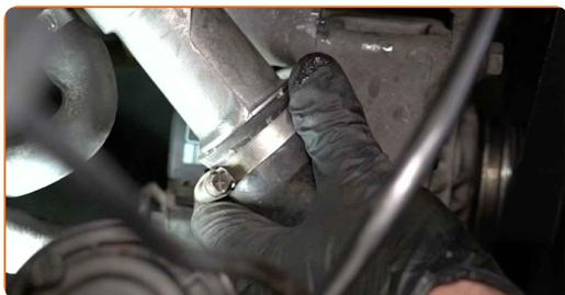
**29** Fixez le collier de serrage du tuyau de refroidissement. Utilisez une douille n° 7. Utilisez une clé à cliquet.
