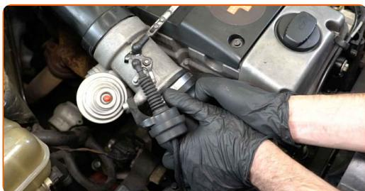
**39** Serrez les colliers de serrage du filtre à air. Utilisez une douille n° 7. Utilisez une clé à cliquet.
