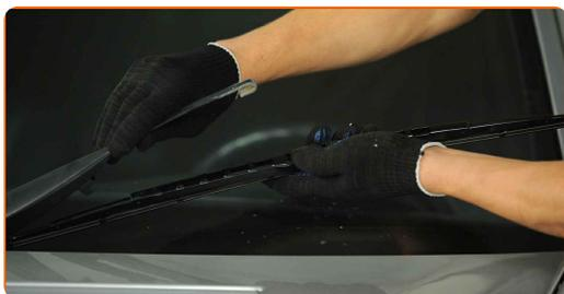
Remplacement : essuie-glaces – MERCEDES-BENZ SPRINTER 3,5-t Camion plate-forme/Châssis (907, 910). Conseil d'AUTODOC :
