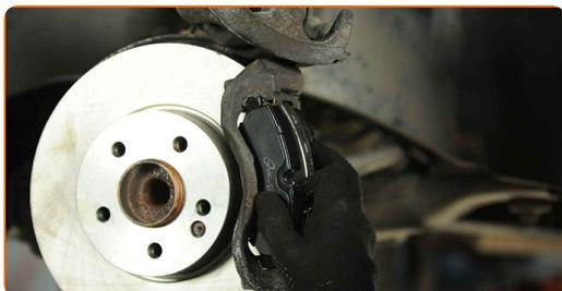
**Remplacement : plaquettes de frein – MERCEDES-BENZ Sprinter 3,5-T Van (907, 910). Les professionnels recommandent :**
