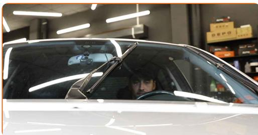
8 Après installation, vérifiez la performance des essuie-glaces. Les balais ne doivent pas s'entrechoquer ni cogner contre le joint du pare-brise.
