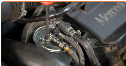
**5** Débranchez le tuyau du filtre à carburant.
