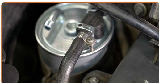
**13** Installez le capteur de pression du carburant.
