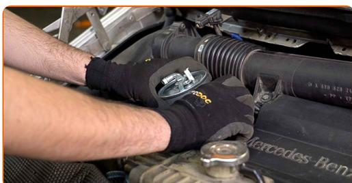
Remplacement : filtre à carburant – MERCEDES-BENZ SPRINTER 4-t Camion plate-forme/Châssis (904). Conseil des experts d'AUTODOC :
