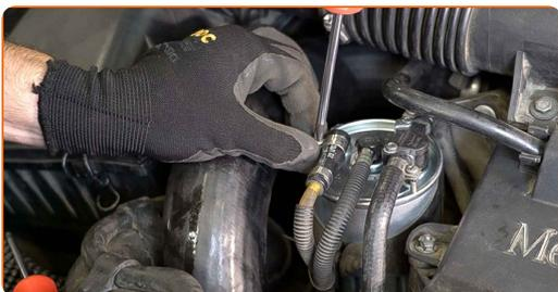
**17** Serrez les attaches du filtre à carburant. Utilisez une douille n° 10. Utilisez une clé à cliquet.
