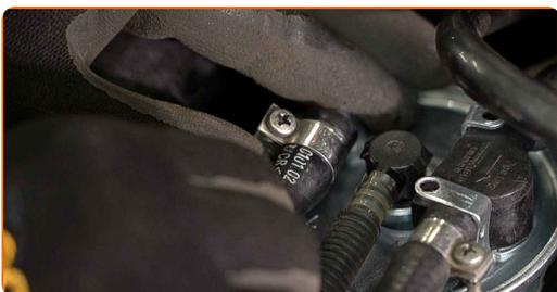
**15** Vissez la fixation reliant la conduite d'alimentation en carburant au carter du filtre à carburant. Servez-vous d'un tournevis Phillips.
