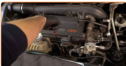
Remplacement : huile moteur et filtre à huile – MERCEDES-BENZ Sprinter 4-T Van (W904). Les experts d'AUTODOC recommandent :
