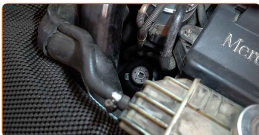
**20** Vissez le bouchon. Utilisez la douille 76-14F. Utilisez une clé dynamométrique. Serrez-le jusqu'à 25 Nm.
