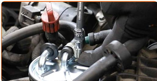
**16** Appuyez sur la pompe d'amorçage du carburant à plusieurs reprises jusqu'à ce qu'elle se durcisse. Utilisez une poire d'amorçage manuelle.
