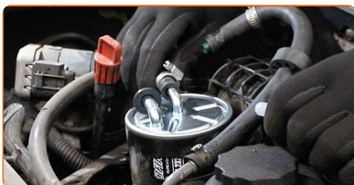
**15** Serrez le collier de serrage du tuyau du filtre à carburant. Utilisez une douille n° 5.5. Utilisez une clé à cliquet.
