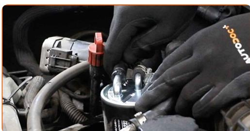
**18** Serrez le collier de serrage du tuyau du filtre à carburant. Utilisez une douille n° 7. Utilisez une clé à cliquet.
