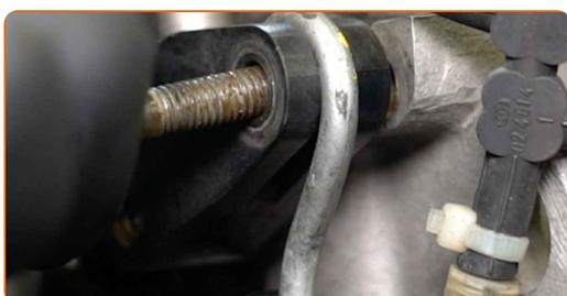
**8** Vissez le boulon de fixation du tendeur de courroie. Utilisez une clé mixte de No.16 (2 pièces).
