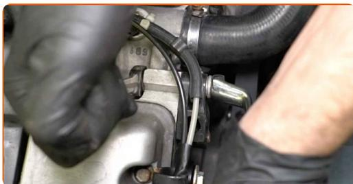
**4** Utilisez un levier du bon diamètre pour desserrer le tendeur et retirer le boulon de fixation. Utilisez une rallonge de barre d'entraînement carrée 3/8".
