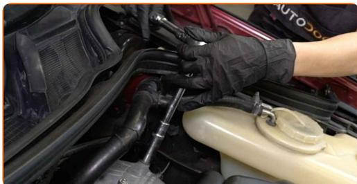
**7** Retirez le bouchon du boîtier du filtre à huile.
