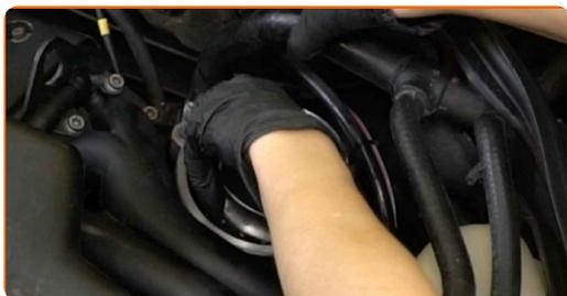
**24** Installez le bouchon du boîtier du filtre à huile.
