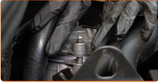
**25** Serrez les fixations du bouchon du boîtier du filtre à huile. Utilisez une douille n° 13. Utilisez une clé dynamométrique. Serrez-le jusqu'à 25 Nm.
