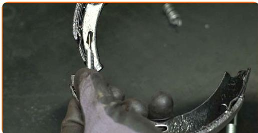
**28** Installez le dispositif de réglage du frein de stationnement.
