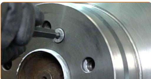
**36** Serrez les fixations du disque de frein. Utilisez la clé HEX n° H5. Utilisez une clé dynamométrique. Serrez-le jusqu'à 10 Nm.
