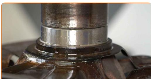
Remplacement : roulement de roue – MERCEDES-BENZ Vaneo (414). Les experts d'AUTODOC recommandent :
