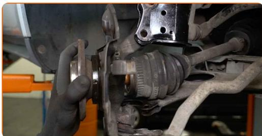
**45** Installez l'écrou de fixation.
