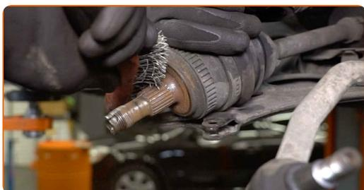
**44** Installez la fusée d'essieu et moyeu dans l'assemblage. Installez l'arbre d'entraînement.
