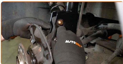
**50** Vissez les fixations reliant la jambe de suspension à la fusée d'essieu. Utilisez une clé mixte de No.18 Utilisez une douille n° 18. Utilisez une clé à cliquet.
