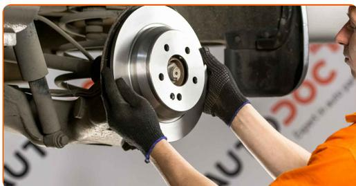
**21** Serrez l'attache du disque de frein. Utilisez la mèche Torx T30. Utilisez une clé dynamométrique. Serrez-le jusqu'à 18 Nm.
