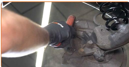
**14** Dévissez l'attache du support d'étrier. Utilisez une douille n° 18. Utilisez une clé à cliquet. Utilisez un porte-taraud.
