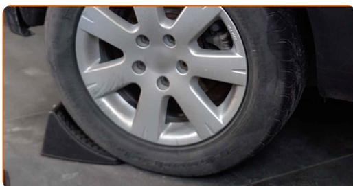
**3** Desserrez les boulons de fixation de la roue. Servez-vous d'une douille à choc pour roue N°17.
