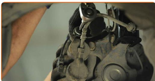
**35** Connectez le connecteur du capteur d'usure de la plaquette de frein.
