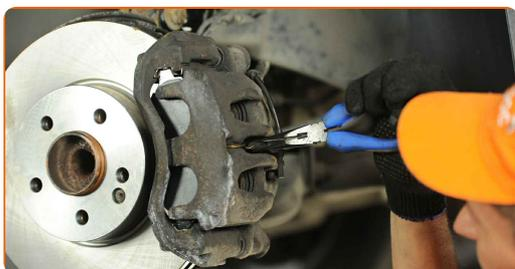
**36** Installez les bouchons anti-poussière des goupilles de guidage de l'étrier de frein. Utilisez un tournevis plat.
