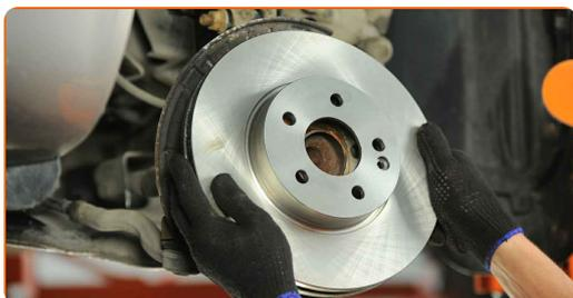
**23** Serrez l'attache du disque de frein. Utilisez la mèche Torx T30. Utilisez une clé dynamométrique. Serrez-le jusqu'à 18 Nm.
