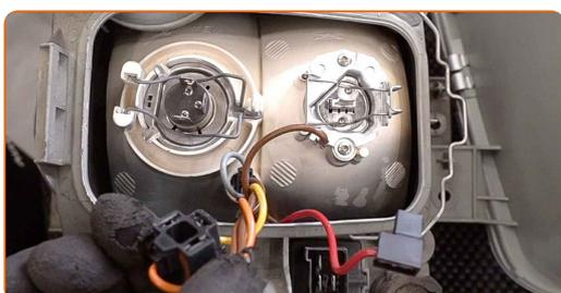
15 Détachez les fixations et retirez les ampoules du phare.
