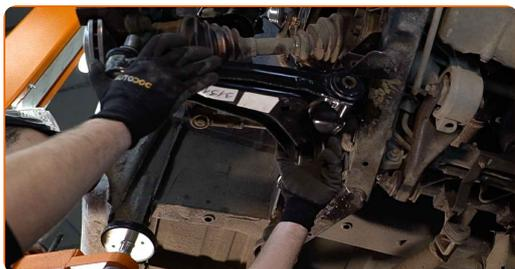
Remplacement : bras inférieur avant – MERCEDES-BENZ Vito Van (W638). Les experts d'AUTODOC recommandent :
