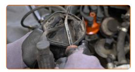
Insérez le nouveau câble haute tension dans le couvercle de la bobine d'allumage.
