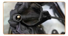
Connectez le câble haute tension à la bobine d'allumage.
