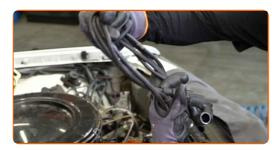
Appliquez du produit sur les bornes du distributeur d'allumage. Utilisez une brosse métallique. Utilisez de la graisse diélectrique.
