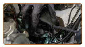
Installez le support du câble haute tension.
