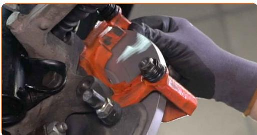
**47** Installez les boulons de fixation.
