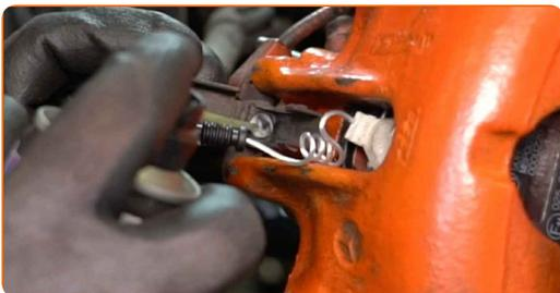
**66** Branchez le connecteur du capteur d'usure de plaquette de frein.
