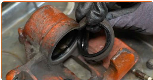
**32** Retirez le joint torique du piston de l'étrier. Utilisez un tournevis plat.
