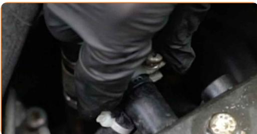
**12** Débranchez le tuyau du filtre à carburant.
