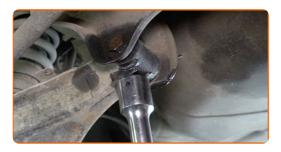
Dévissez la fixation reliant le bras de commande au sous-châssis. Utilisez une clé mixte de No.19 Utilisez une douille n° 19. Utilisez une clé à cliquet.
