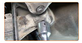
35 Installez l'écrou de fixation.
