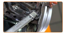
Serrez la fixation reliant le bras de commande au sous-châssis. Utilisez une clé mixte de No.19 Utilisez une douille n° 19. Utilisez une clé dynamométrique. Serrez-le jusqu'à 70 Nm.
