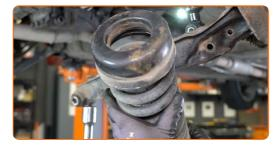
Nettoyez les emplacements de montage des ressorts hélicoïdaux. Utilisez une brosse métallique. Servez-vous d'un aérosol nettoyant multi-usages.
