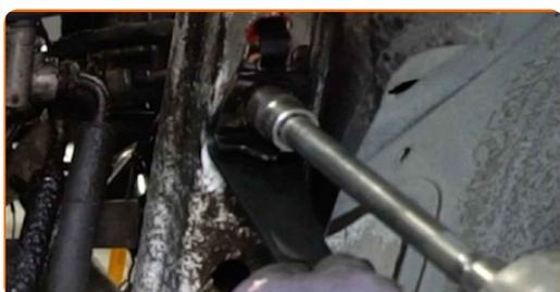
**21** Installez les boulons de fixation.
