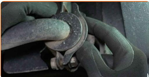
**45** Serrez les fixations des supports de douille de barre stabilisatrice. Utilisez une clé mixte de No.13 Utilisez une douille n° 13. Utilisez une clé dynamométrique. Serrez-le jusqu'à 20 Nm.
