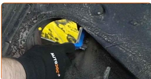
**32** Nettoyez le siège de montage du support de jambe de suspension. Utilisez une brosse métallique. Servez-vous d'un aérosol nettoyant multi-usages.
