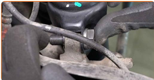
**40** Serrez les fixations inférieures sur les amortisseurs. Utilisez une douille n° 19. Utilisez une clé dynamométrique. Serrez-le jusqu'à 110 Nm.
