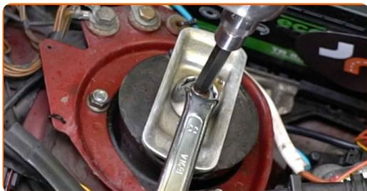
**Remplacement : coupelle d'amortisseur – MERCEDES-BENZ W124 Break (S124). AUTODOC recommande :**
