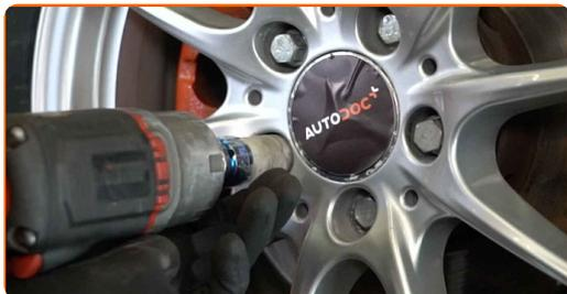
**52** Abaissez la voiture et serrez les boulons de roue en ordre croisé. Servez-vous d'une douille à choc pour roue N°17. Utilisez une clé dynamométrique. Serrez-le jusqu'à 110 Nm.
