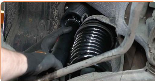
**38** Vissez la fixation de la tige de piston de la jambe de suspension.
