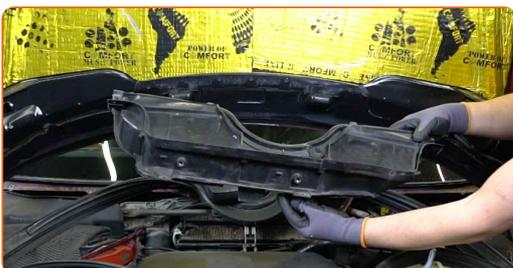
**9** Recouvrez le filtre d'habitacle d'un chiffon en microfibre pour empêcher la saleté et les corps étrangers d'y pénétrer.
