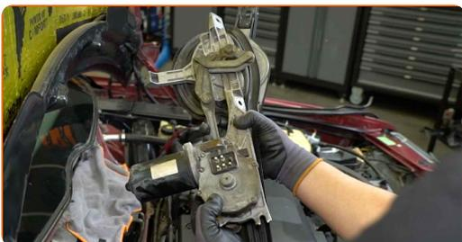
**14** Tracez une marque indiquant l'angle d'installation de la tringlerie d'essuie-glace. Utilisez une règle.
