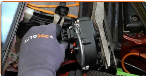
**31** Serrez les fixations du mécanisme d'essuie-glace. Utilisez une douille n° 10. Utilisez une clé dynamométrique. Serrez-le jusqu'à 13 Nm.
