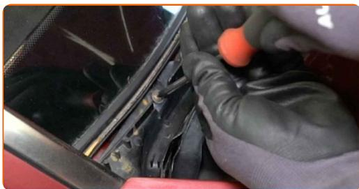
**36** Installez la moulure en caoutchouc du pare-brise.
