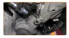
15 Retirez l'écrou de fixation.
