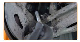
Détachez le joint à rotule de la fusée d'essieu.
