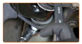
Serrez la fixation avant du bras de commande. Utilisez une clé mixte de No.22 Utilisez une douille n° 22. Utilisez une clé dynamométrique. Serrez-le jusqu'à 120 Nm.
