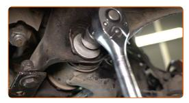
Dévissez la fixation avant du bras de commande. Utilisez une clé mixte de No.22 Utilisez une douille n° 22. Utilisez une clé à cliquet.
