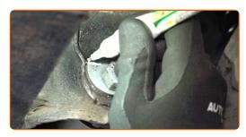
Dévissez la fixation arrière du bras de commande. Utilisez une clé mixte de No.22 Utilisez une douille n° 22. Utilisez une clé à cliquet.
