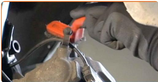
**9** Dévissez l'attache de l'étrier de frein. Utilisez une douille n° 12. Utilisez une clé à cliquet.
