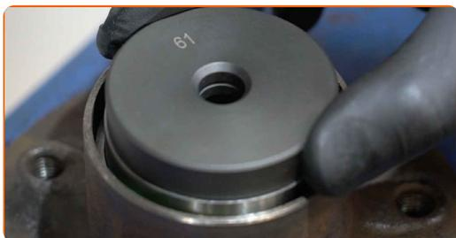
**35** Appliquez du produit sur le siège de fixation de l'ensemble de roulement. Servez-vous d'une graisse multi-usages.
