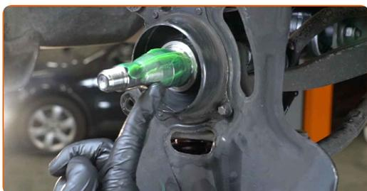
**49** Installez le nouveau moyeu de roue avec un roulement.
