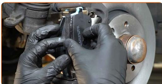
**61** Installez l'étrier de frein et fixez-le. Utilisez une douille n° 12. Utilisez une clé dynamométrique. Serrez-le jusqu'à 25 Nm.
