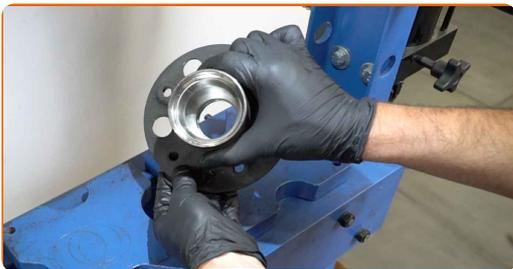
**30** Tirez la bague de roulement intérieure du moyeu de roue. Utilisez un coffret de douilles et de roulements.
