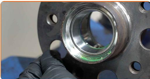
**38** Appliquez du produit sur le siège de fixation de l'ensemble de roulement. Servez-vous d'une graisse multi-usages.
