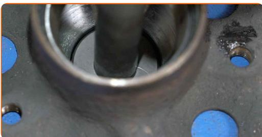
**31** Tirez la bague de roulement intérieure du moyeu de roue. Servez-vous d'un extracteur d'engrenage à 3 bras. Utilisez un coffret de douilles et de roulements.
