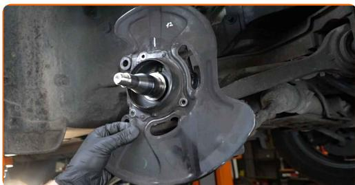
**47** Vissez les fixations sur la protection de disques de frein. Utilisez une douille n° E12. Utilisez une clé dynamométrique. Serrez-le jusqu'à 11 Nm.
