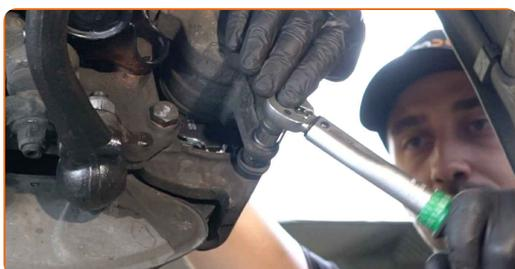
**62** Connectez le connecteur du capteur d'usure de la plaquette de frein.
