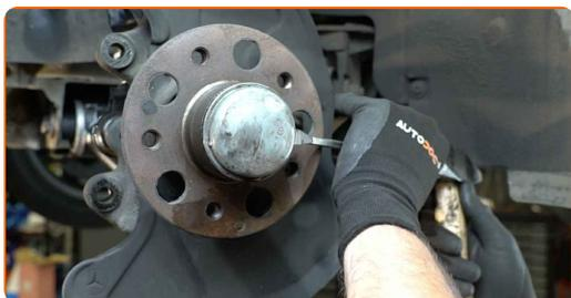
Remplacement : roulement de roue – MERCEDES-BENZ W124 Coupe (C124).
