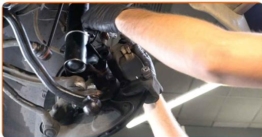
**59** Serrez le support de l'étrier de frein. Utilisez une douille n° 18. Utilisez une clé dynamométrique. Serrez-le jusqu'à 115 Nm.
