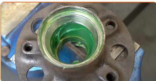
**39** Installez un nouveau roulement de moyeu de roue.
