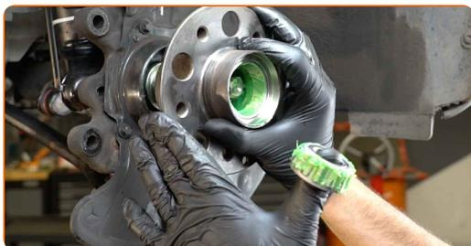
**50** Installez un nouveau roulement de moyeu de roue.
