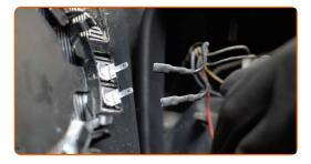
Appliquez du produit sur les connecteurs de chauffage du miroir. Utilisez de la graisse diélectrique.
