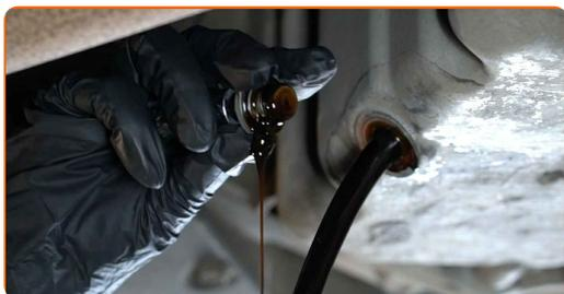
Remplacement : huile moteur et filtre à huile – Opel Meriva X03. Les professionnels recommandent :
