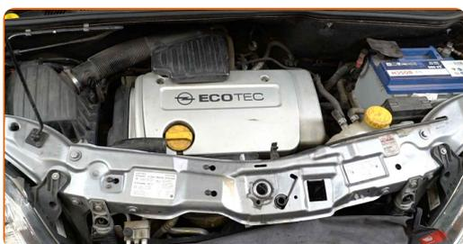
**26** Vérifiez le niveau d'huile cinq minutes après l'arrêt du moteur à l'aide d'une jauge, et ajoutez de l'huile si nécessaire.
