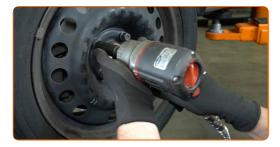
Abaissez la voiture et serrez les boulons de roue en ordre croisé. Servez-vous d'une douille à choc pour roue N°17. Utilisez une clé dynamométrique. Serrez-le jusqu'à 110 Nm.
