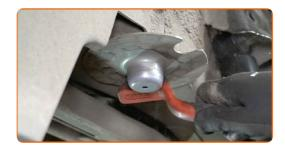
Installez un nouveau ressort hélicoïdal avec ses supports en caoutchouc sur les emplacements de montage.
