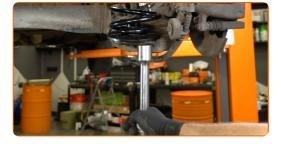
Serrez l'attache de l'amortisseur supérieur. Utilisez une douille n° E18. Utilisez une clé dynamométrique. Serrez-le jusqu'à 90 Nm.
