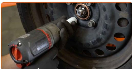
**25** Abaissez la voiture et serrez les boulons de roue en ordre croisé. Servez-vous d'une douille à choc pour roue N°17. Utilisez une clé dynamométrique. Serrez-le jusqu'à 110 Nm.
