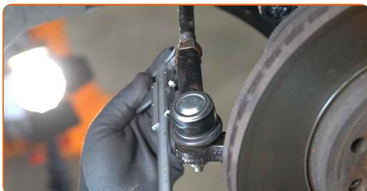
**18** Serrez l'écrou de blocage de l'extrémité de la barre. Utilisez une clé mixte de No.21 (2 pièces). Utilisez une clé dynamométrique. Serrez-le jusqu'à 55 Nm.
