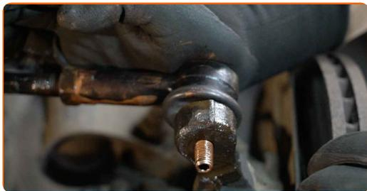
**15** Appliquez du produit sur la fixation reliant l'embout de biellette de direction à la fusée d'essieu. Utilisez de la graisse au cuivre.
