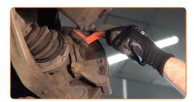
Dévissez l'attache du support d'étrier. Utilisez une douille n° 17. Utilisez une clé à cliquet.
