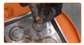
Appliquez du produit sur les boulons de guidage de l'étrier de frein. Appliquez la graisse pour les boulons de guidage de l'étrier de frein.
