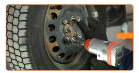
Abaissez la voiture et serrez les boulons de roue en ordre croisé. Servez-vous d'une douille à choc pour roue N°19. Utilisez une clé dynamométrique. Serrez-le jusqu'à 110 Nm.
