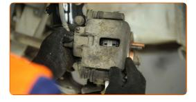
Utilisez une douille n° 12. Utilisez une clé dynamométrique. Serrez-le jusqu'à 30 Nm.
