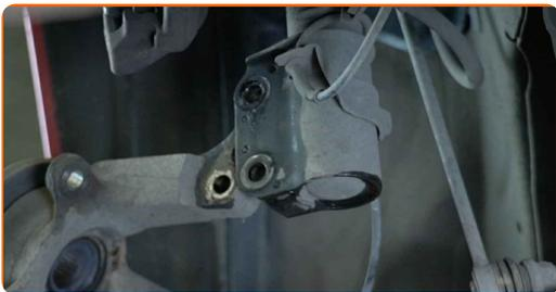
**33** Retirez la fusée d'essieu avec le moyeu de roue.
