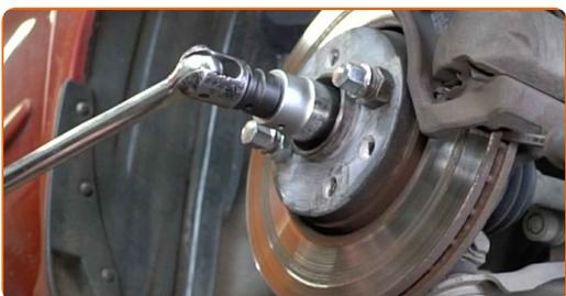
**8** Retirez l'écrou de fixation.
