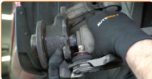
**52** Connectez le joint à rotule à la fusée d'essieu.
