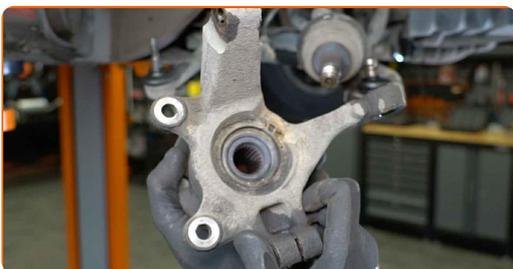
**34** Retirez le moyeu de roue de la fusée d'essieu. Utilisez un coffret de douilles et de roulements.
