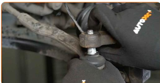
**55** Serrez l'écrou de fixation reliant l'embout de biellette de direction à la fusée d'essieu. Utilisez une douille n° 14. Utilisez une clé dynamométrique. Serrez-le jusqu'à 35 Nm.
