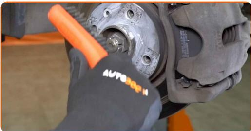
**7** Dévissez les fixations qui lient l'arbre de transmission au moyeu de roue. Utilisez une douille n° 30. Utilisez un porte-taraud.
