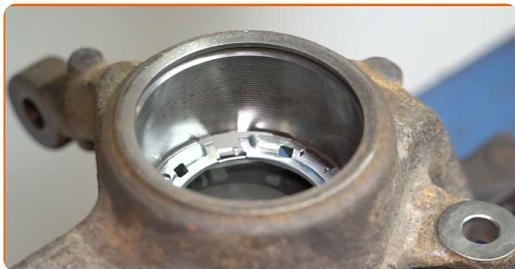
**41** Insérez le roulement neuf dans la fusée d'essieu. Utilisez un coffret de douilles et de roulements.
