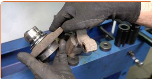
**35** Nettoyez la bague de retenue du roulement de moyeu de la roue. Utilisez une brosse métallique. Servez vous de l'aérosol WD-40.
