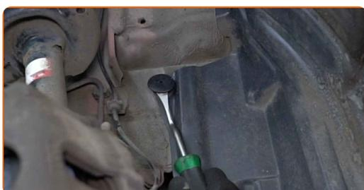
**7** Desserrez l'attache du galet tendeur. Utilisez une clé mixte de No.14.
