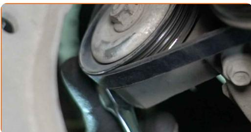
Remplacement : courroie poly V – Nissan Micra K12. AUTODOC recommande :
