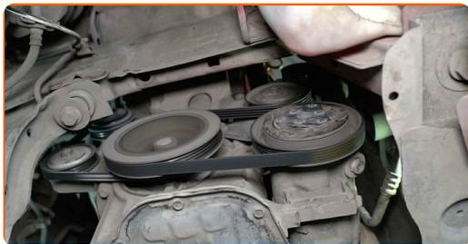
Remplacement : courroie poly V – Nissan Micra K12. Les professionnels recommandent :
