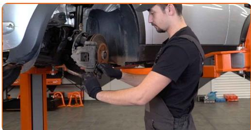
**10** Retirez les bouchons anti-poussière des goupilles de guidage de l'étrier de frein.
