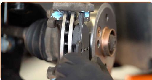
Remplacement : plaquettes de frein – MINI Cabriolet (R52). Les professionnels recommandent :
