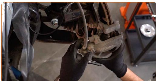
Remplacement : plaquettes de frein – MINI Cabriolet (R52). AUTODOC recommande :
