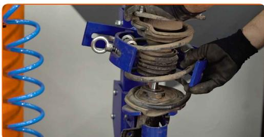
Remplacement : jambe de suspension – MINI Cabriolet (R52). Les experts d'AUTODOC recommandent :
