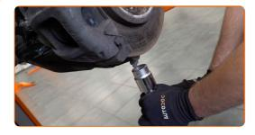
Sécurisez le stabilisateur sur l'entretoise de suspension. Utilisez une douille n° 16. Utilisez une clé dynamométrique. Serrez-le jusqu'à 56 Nm.
