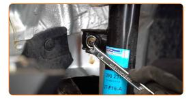
Dévissez la fixation inférieure assurant la connexion entre la jambe d'amortisseur et le porte-fusée. Servez vous de la douille XZN n°14. Utilisez une clé à cliquet. Utilisez un porte-taraud.
