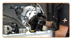
Fixer les fixations supérieures de l'amortisseur (3 pièces). Ne serrez pas trop.
