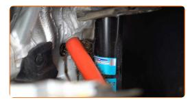
Dévissez l'écrou et retirez la barre stabilisatrice de l'entretoise de l'amortisseur. Utilisez une clé mixte de No.16. Utilisez la clé HEX n° H6. Utilisez une clé à cliquet.
