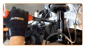
Connectez l'attache du câble du capteur ABS de l'entretoise de support de l'amortisseur. Attachez le tuyau de frein à l'entretoise.
