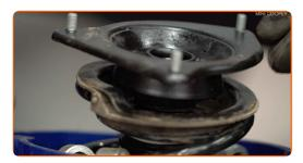
Serrez l'écrou de l'entretoise d'amortisseur due la tige de piston. Utilisez une douille n° 18. Utilisez une clé mixte de No.18 Utilisez la clé HEX n° H7. Utilisez une clé dynamométrique. Serrez-le jusqu'à 64 Nm.
