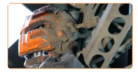
Connectez le capteur d'usure des plaquettes de frein.
