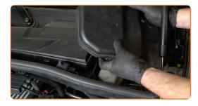
Dévissez le bouchon du réservoir de liquide de frein.
