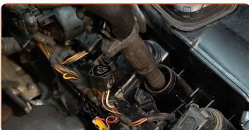
**16** Occupez-vous des embouts de la bobine d'allumage. Servez-vous d'une graisse haute-température. Utilisez un tournevis plat.
