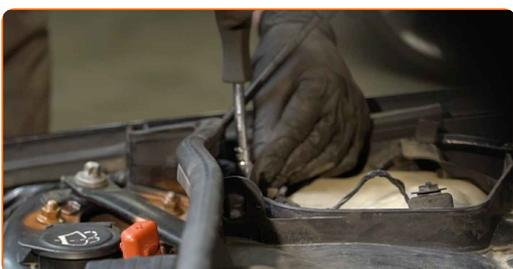
9 Détachez le conduit de câbles de la partie supérieure du boîtier pour microfiltre. Utilisez un tournevis plat.
