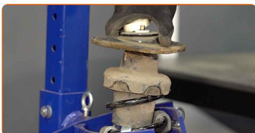
**16** Serrez l'écrou de l'entretoise d'amortisseur due la tige de piston. Utilisez la clé HEX n° H6. Utilisez une clé mixte de No.19. Utilisez une clé dynamométrique. Serrez-le jusqu'à 30 Nm.
