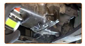
Dévissez le bouchon de vidange. Utilisez une douille n° 21. Utilisez une clé à cliquet.
