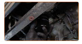
Serrez le filtre à huile. N'oubliez pas de respecter le couple de serrage recommandé. Utilisez la douille 76-14F. Utilisez une clé dynamométrique. Serrez-le jusqu'à 24 Nm.
