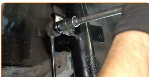
**76** Appliquez du produit sur les fixations de l'amortisseur. Appliquez du produit sur tous les joints du stabilisateur. Appliquez du produit sur les fixations de la fusée arrière. Utilisez de la graisse au cuivre.
