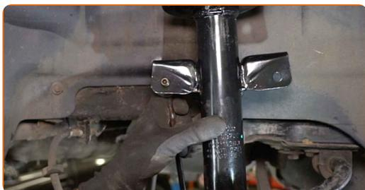
**74** Resserez la fixation de la biellette de la barre stabilisatrice. Utilisez une douille n° 17. Utilisez une clé à cliquet.
