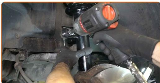
**75** Serrez la fixation reliant la biellette à l'amortisseur. Utilisez une douille n° 17. Utilisez une clé dynamométrique. Serrez-le jusqu'à 48 Nm.
