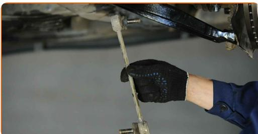
**Remplacement : biellette de barre stabilisatrice – VW Multivan T5. Les professionnels recommandent :**
