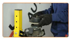
Serrez l'écrou de l'entretoise d'amortisseur due la tige de piston. Utilisez une douille n° 21. Utilisez la clé HEX n° H7. Utilisez une clé dynamométrique. Serrez-le jusqu'à 80 Nm.
