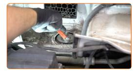
Dévissez les fixations supérieures du support de la jambe de suspension. Utilisez une clé mixte de No.21 Utilisez la clé HEX n° H7. Utilisez une clé à cliquet.
