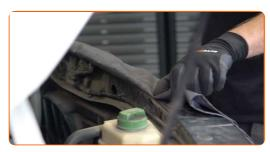
Débranchez le connecteur du débimètre d'air. Utilisez un tournevis plat. 29
