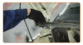
Dévissez les boulons de fixation du couvercle de protection. Utilisez la mèche Torx T30. Utilisez une clé à cliquet.
