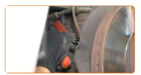
Dévissez les fixations reliant la jambe de suspension à la fusée d'essieu. Utilisez une douille n° 18. Utilisez une clé à cliquet.
