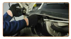
Serrez les boulons de fixation du couvercle de protection. Utilisez la mèche Torx T30. Utilisez une clé à cliquet.
