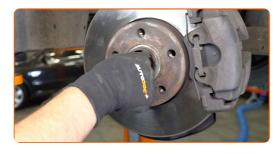
Resserrez l'écrou de l'arbre de transmission. Utilisez une douille n° 30. Utilisez une clé dynamométrique. Serrez-le jusqu'à 200 Nm.
