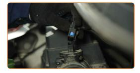
Déverrouillez les clips du couvercle du filtre à air. 30
