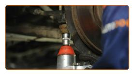
90 Installez l'écrou de fixation.
