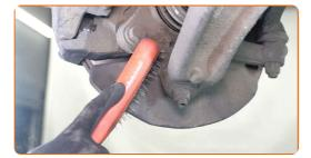
Dévissez les fixations du joint à rotule de la fusée d'essieu. Utilisez une douille n° 19. Utilisez une clé à cliquet.
