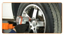
Abaissez la voiture et serrez les boulons de roue en ordre croisé. Servez-vous d'une douille à choc pour roue N°19. Utilisez une clé dynamométrique. Serrez-le jusqu'à 180 Nm.
