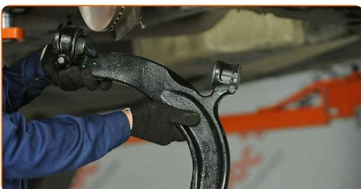
Remplacement : bras inférieur avant – VW Multivan T5. Les professionnels recommandent :
