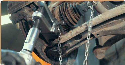
**29** Appuyez la mâchoire supérieure de l'outil contre le pivot à rotule et poussez le joint hors de son siège de montage
