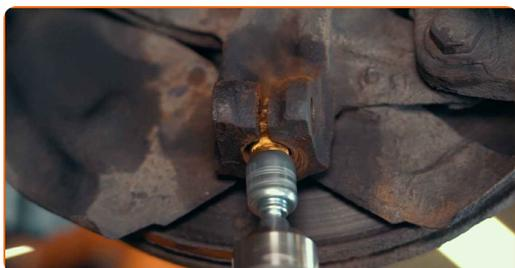
**22** Appliquez du produit anticorrosion sur le siège de fixation du pivot à rotule
