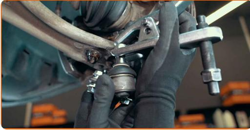
**28** Le joint à rotule peut être retiré à l'aide d'un extracteur de joint à rotule. La mâchoire inférieure de l'outil doit être placée sous un composant, par exemple le porte-fusée, pour le soutenir.
