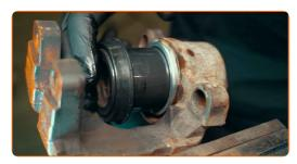
Tout en continuant à pousser le piston avec précaution, insérez-le dans le boîtier. Utilisez un repousse-piston sur l'étrier de frein
