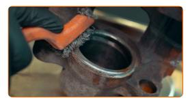
Si le soufflet de protection est installé à l'intérieur du composant, nettoyez soigneusement son siège de montage
