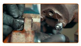
Vérifiez qu'il n'y a ni corrosion ni dommage sur le siège conique de la vis de purge dans le boîtier de l'étrier
