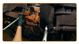
Desserrez la vis de purge et retirez le collier de serrage du tuyau pour permettre au liquide de frein de s'écouler dans l'étrier
