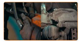
Si l'étrier ne peut être détaché, insérez un outil approprié entre son logement et le disque de frein
