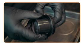
Insérez ensuite le piston dans le boîtier de l'étrier et installez le soufflet de protection
