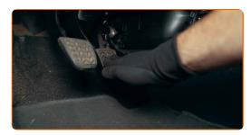
Remplissez l'étrier de frein avec du liquide en chassant l'air à travers la vis de purge
