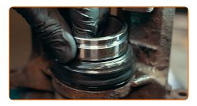
Placez délicatement le piston sur son siège de montage et poussez-le légèrement jusqu'à ce qu'il entre en contact avec le joint
