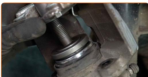
**6** Si les étriers de frein arrière sont équipés d'un mécanisme de frein de stationnement, il faut également faire tourner leurs pistons lorsque vous les repoussez. Utilisez un outil spécial avec des adaptateurs
