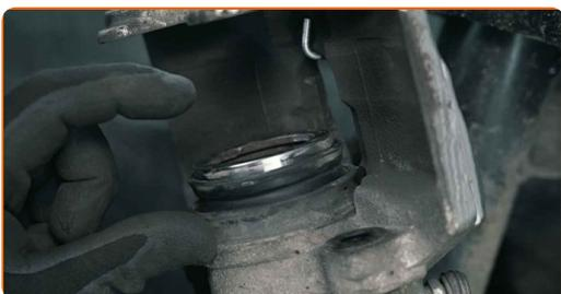
**36** Il doit être repoussé dans sa position initiale avant d'installer les nouvelles plaquettes de frein. Utilisez un outil spécial pour repousser le piston de l'étrier de frein
